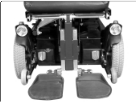
Afbeelding 3. Verlichting, richtingaanwijzers en reflectoren voorkant
