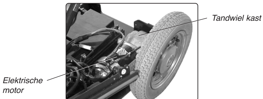
Afbeelding 6. Elektrische motor met tandwiel kast.
