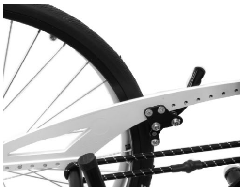
Bromsmekanismen sitter monterad med två skruvar.
