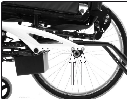
Hjulinfästningen fixeras med två skruvar.
