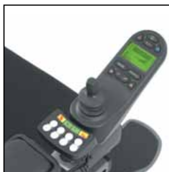
R-net elektronikk med ICS. Du kan bruke alle el.funksjoner, alternative styresystemer og har dessuten mulighet for å lagre favorittposisjoner.
