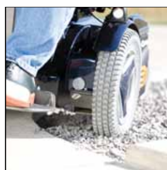
C500 har ESP (Enhanced Steering Performance) som standard. Systemet korrigerer automatisk retningen på rullestolen ved ujevnt underlag og i høyere hastigheter. Har du en 10 km/t modell, så er ESP et selvskrevent pluss.
