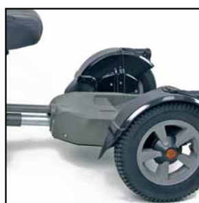
Justerbar akselavstand, som tilbehør også elektrisk regulert.
