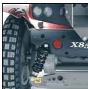
Robust justerbart fjæringssystem, uavhengig fjæring på framhjul.
