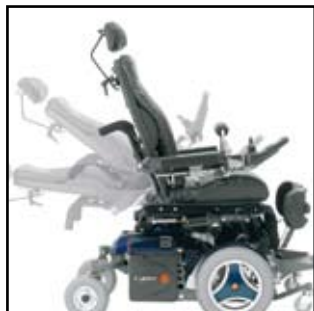
Separat el-regulering af rygsvinkel.
