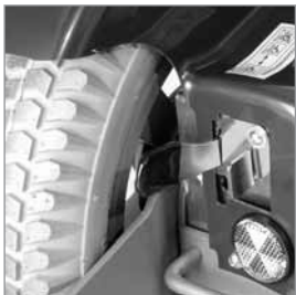
Freins débrayés avec cran d'arrêt
