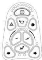
Panneau de commande avec fonctions de phares et d'assise
