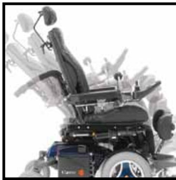
Angetriebene, einstellbare Sitzkantelung
