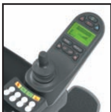
R-Net-elektronica met ICS intelligente besturingssysteem met programmeerbare verstellingen
