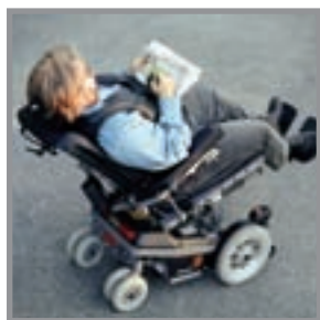
Met de optionele kantelverstelling kan het zitsysteem tot 25° kantelen
