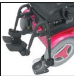
Poggiapiedi facilmente eliminabili con piastre multiassi regolabili a elevata resistenza. Disponibile con ganci frontali a 70° o 90°
